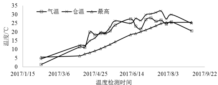
图16 浅圆仓粮堆最外层最高粮温随气温、仓温变化情况
