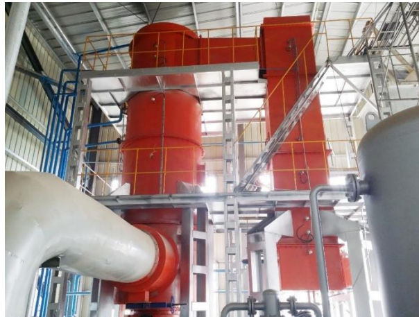
图 1-1 基于生物质富氧高温气化燃烧技术的粮食烘干系统示意图
